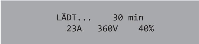
Am Bildschirm werden die Zeit seit Beginn des Ladevorgangs, der Ladestrom, die Spannung und die aktuelle Batterieleistung angezeigt.
