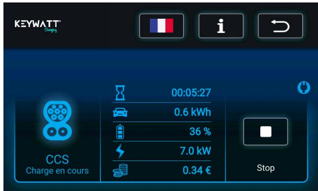
Le chargeur s'arrêtera automatiquement une fois la charge terminée. Le chargeur ajustera sa puissance en fonction des exigences du véhicule, de la température ambiante et d'autres facteurs.
