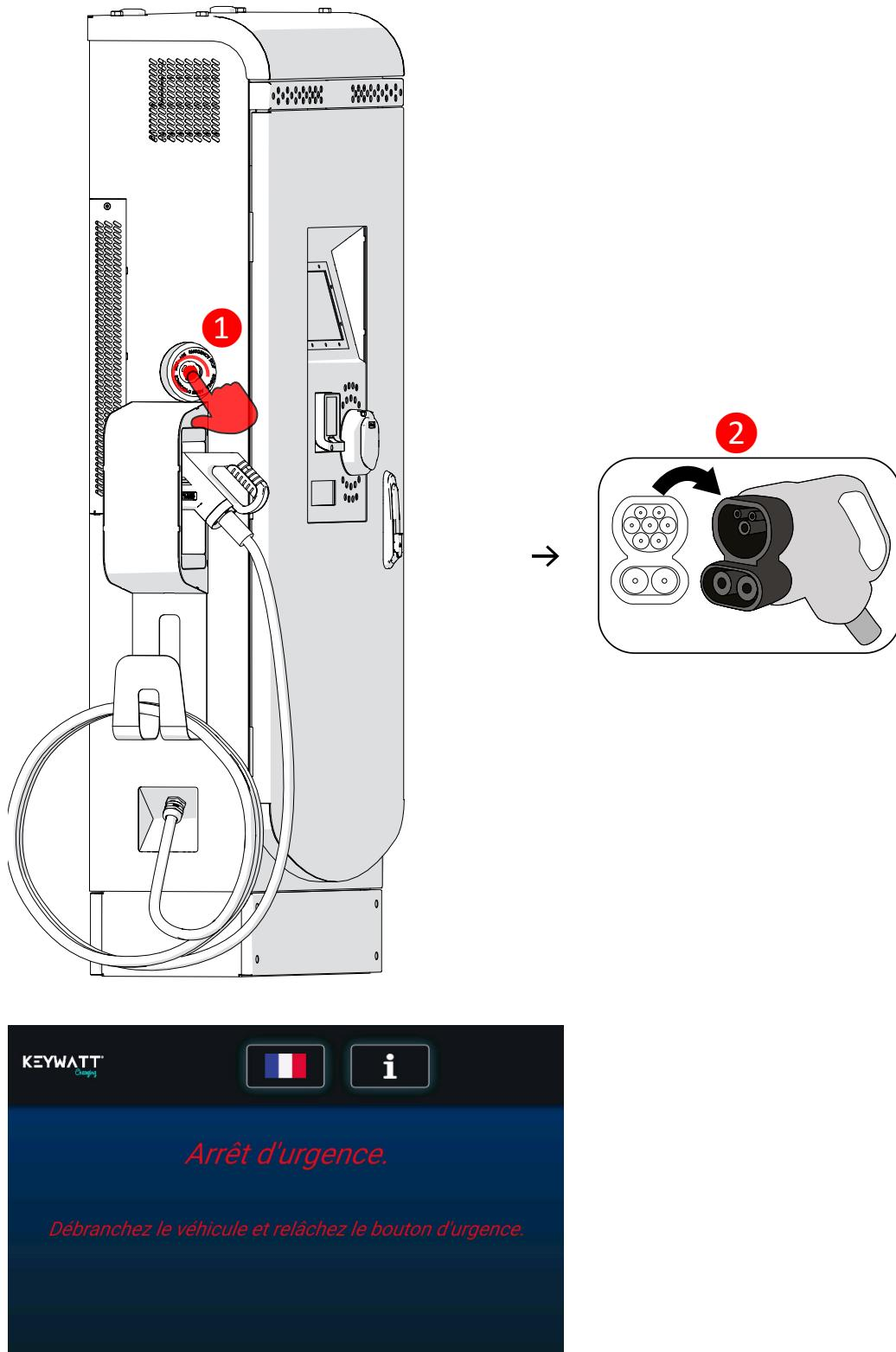
Pour réinitialiser après l'arrêt d'urgence, tourner le bouton dans le sens des aiguilles d'une montre jusqu'à ce qu'il sorte. Après un autotest, l'afficheur supprime le message d'arrêt d'urgence et est prêt pour une nouvelle session.
